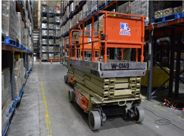
Figura 3.16. Plataforma elevadora utilizada.
