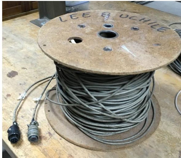
Figura 3.9. Cable con sus respectivos conectores.
