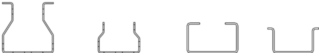
Figura 2.10. Secciones transversales típicas para columnas.
