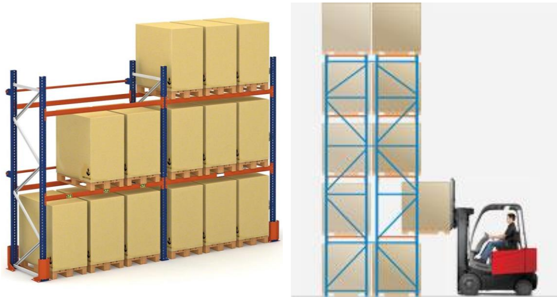
Figura 2.1. Rack selectivo convencional (izquierda) y sistema de carga (derecha).
