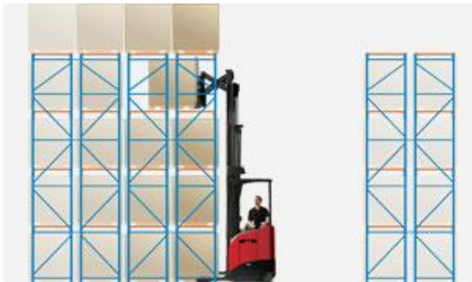
Figura 2.2. Sistema de carga de rack selectivo de doble profundidad.
