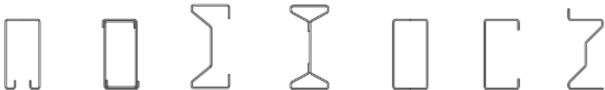
Figura 2.12. Secciones transversales típicas para vigas.
