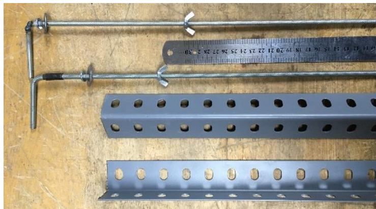
Figura 3.10. Elementos utilizados para la fijación de sensores. Regla de referencia.
