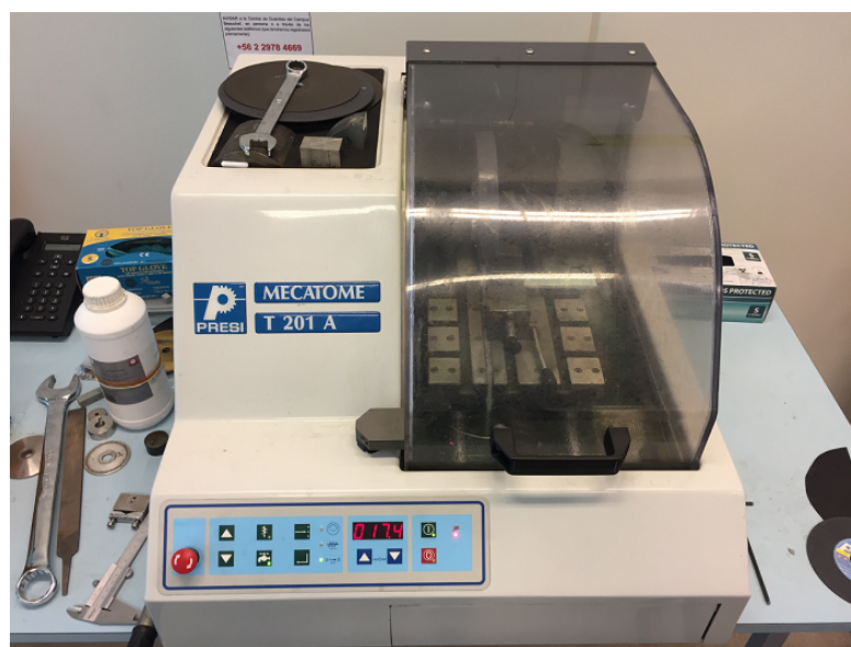
Figura 4.3: Fotografía equipo cortadora metalográfica, vista frontal. Elaboración propia.
