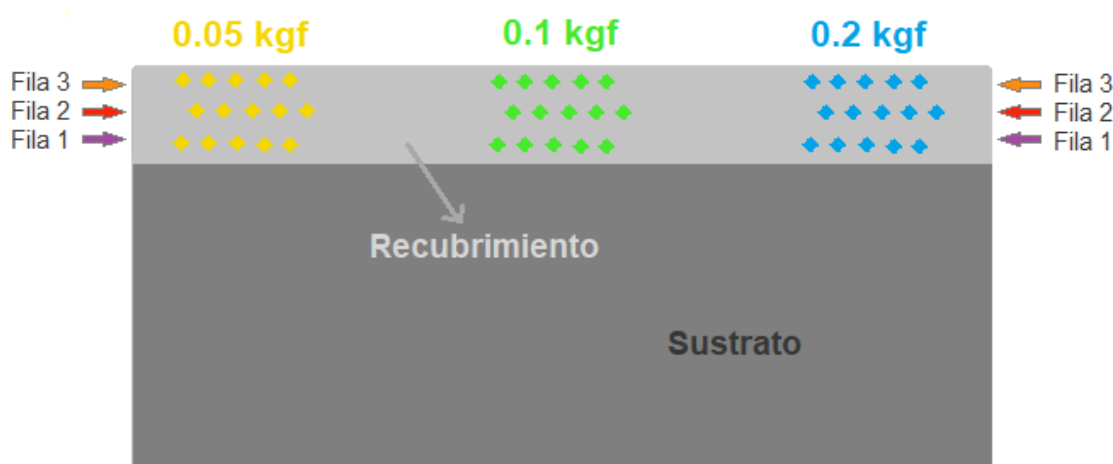
Figura 4.8: Esquema de zonas de medición de dureza. Elaboración propia.
