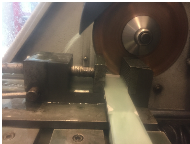
Figura 4.4: Fotografía pieza y mesa de trabajo en cortadora metalográfica, vista lateral. Elaboración propia.
