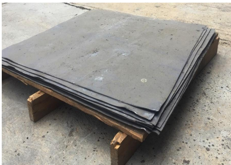
Planchas de plomo compactadas de 3 mm de espesor,
