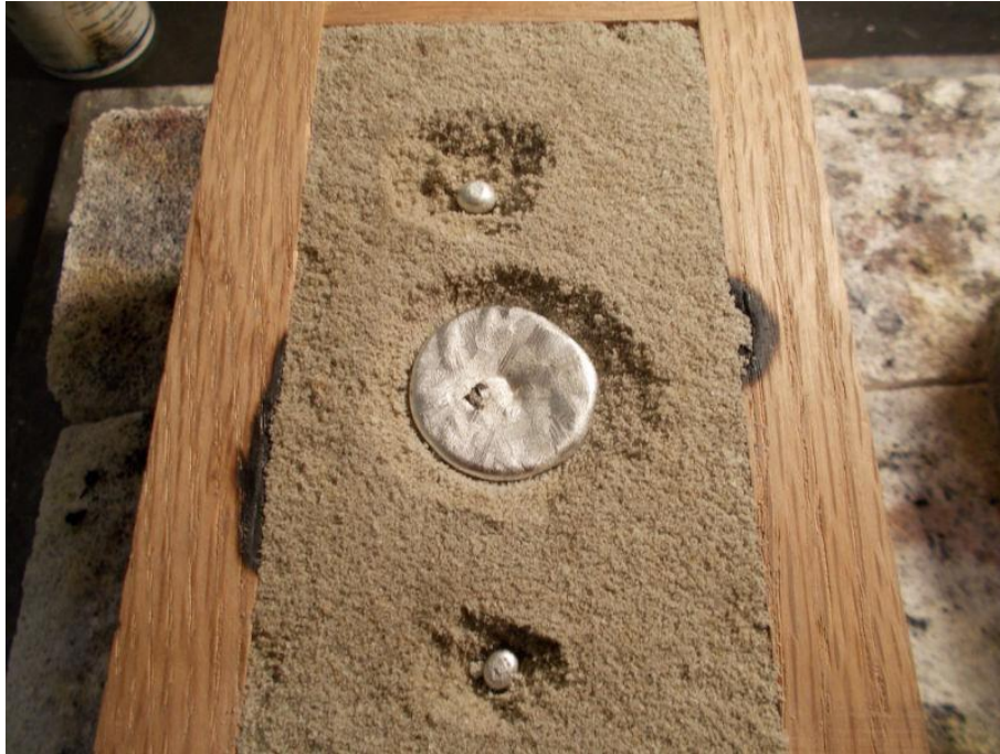
Imagen de referencia. Caja de arena compactada con el modelo enterrado. Jitios de entrada y salida en aluminio.
