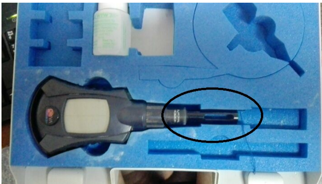
Figura 3.11: Conductímetro WTW 2X00-001A. Ovalo negro: Medidor de conductividad, la separación entre las placas paralelas mide 1 [cm]
