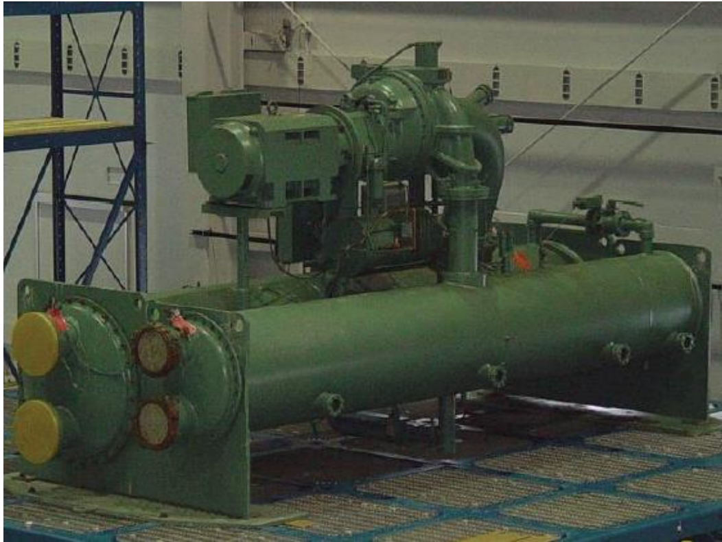
Figura 8.3: Espécimen de prueba de chiller industrial pesado.
