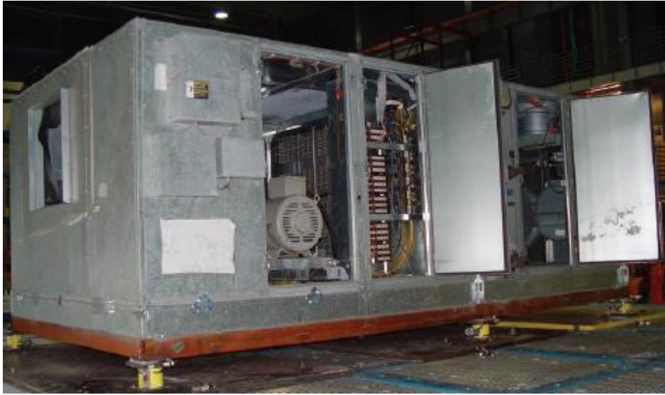
Figura 8.4: Espécimen de prueba de chiller industrial liviano.
