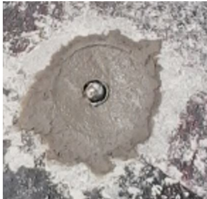
Figura 3.14: Fotografía en planta, punto de control de asentamiento superficial (Montes y Pozo, 2015).
