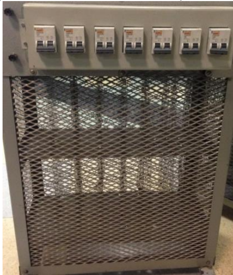
Figura 29: Carga resistiva monofásica.
