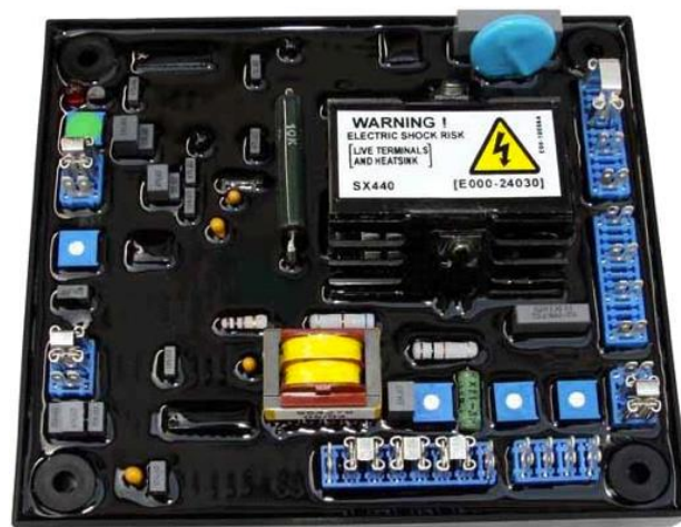
Figura 23: Regulador automático de voltaje SX440
