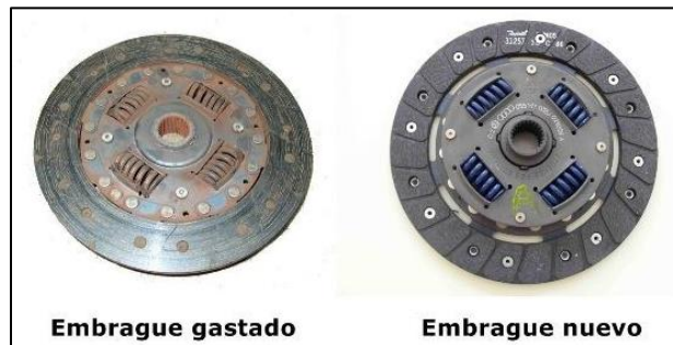
Figura 63 Comparación entre un disco de embrague nuevo y uno gastado.
