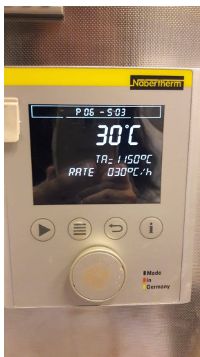
Figura 3.4: Horno Nabertherm ocupado para realizar tratamientos térmicos de sinterizado y recocido
