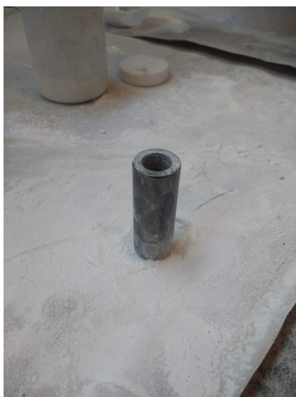
Figura 3.2: Molde utilizado para crear discos
