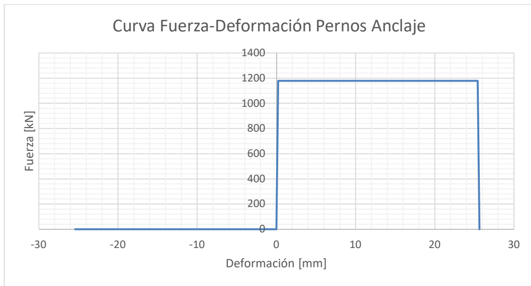
Figura 9.22 Curva envolvente de los pernos de anclaje de la Estructura 3, Diseño 4.
