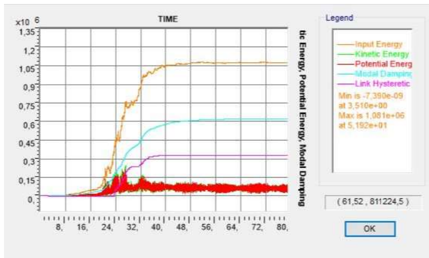
Figura 9.52 Distribución de energía sísmica en el tiempo. Diseño 4.
