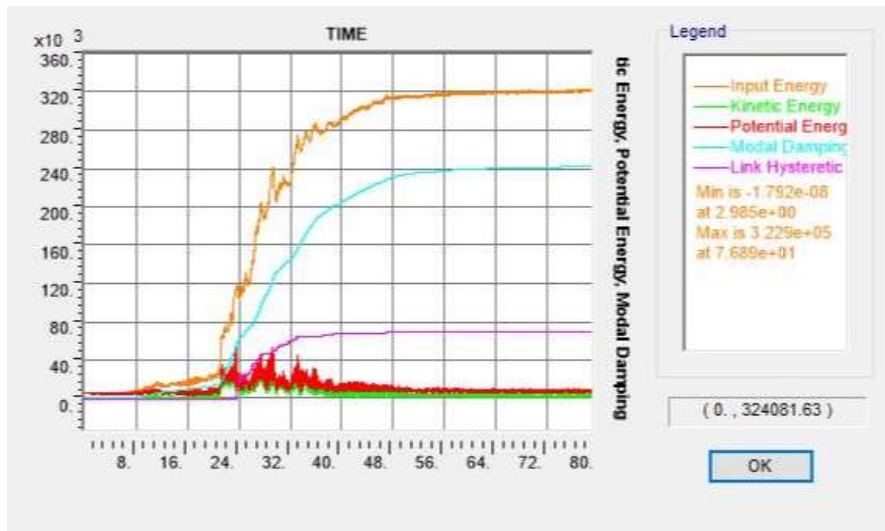
Figura 9.48 Distribución de energía sísmica en el tiempo. Diseño 6.
