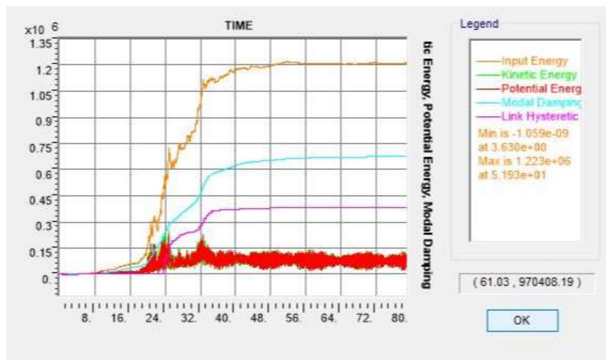
Figura 9.53 Distribución de energía sísmica en el tiempo. Diseño 5.
