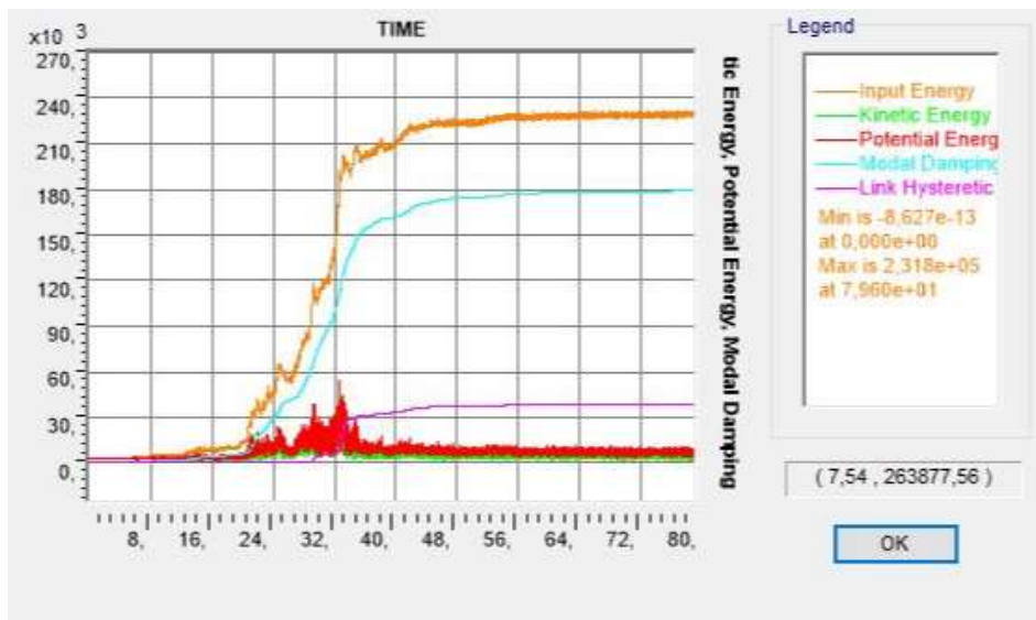
Figura 9.58 Distribución de energía sísmica en el tiempo. Diseño 4.
