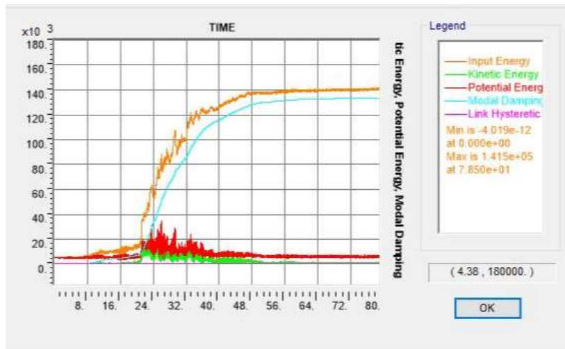
Figura 9.45 Distribución de energía sísmica en el tiempo. Diseño 3.
