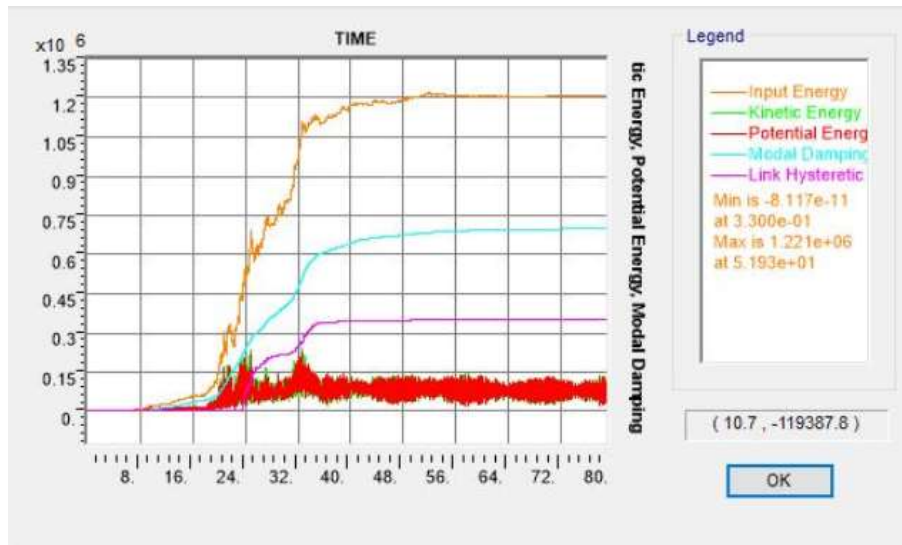
Figura 9.50 Distribución de energía sísmica en el tiempo. Diseño 2.
