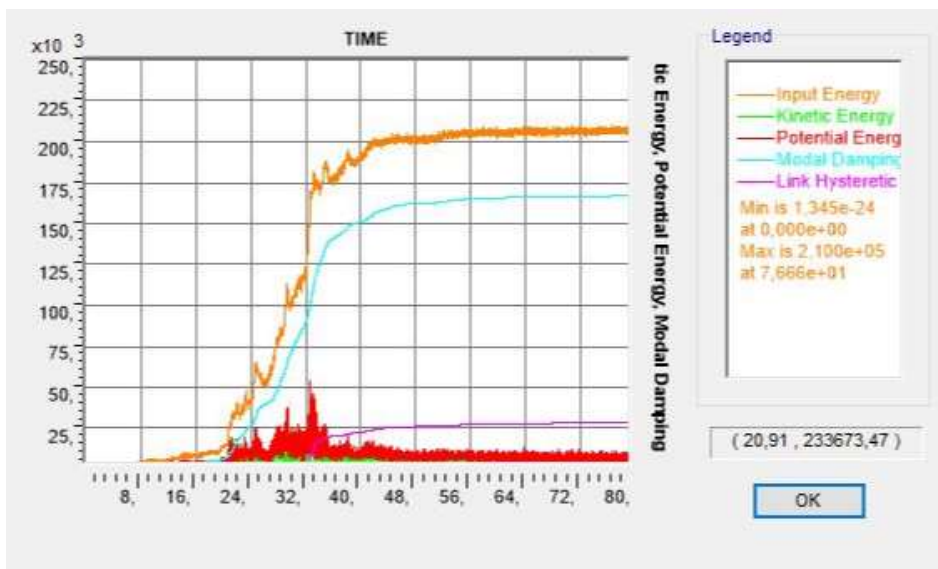
Figura 9.60 Distribución de energía sísmica en el tiempo. Diseño 6.
