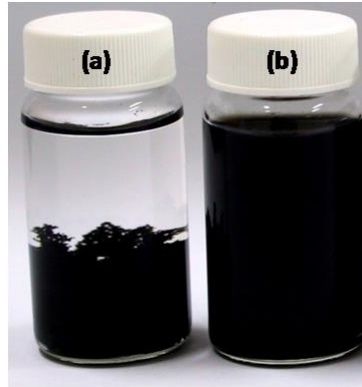
Figura 3. Dispersión de MWNTC. A) Baja estabilidad de la dispersión de nanotubos. B) Dispersión estable de los nanotubos.
