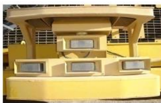
Ilustración 20 – Sistema de detección de obstáculos
