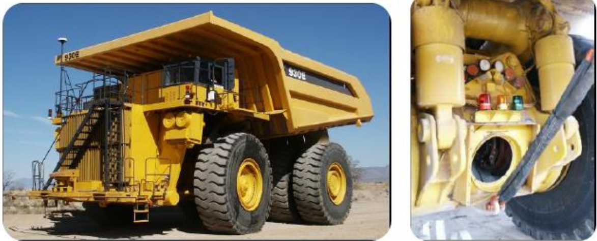
Ilustración 33 – Balizas para interacción Manual-Autónoma
