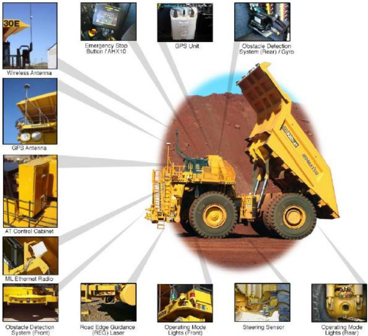
Ilustración 8 – Diagrama componentes camión autónomo (División Gabriela Mistral, 2017)
