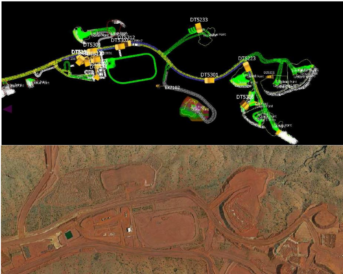
Ilustración 29 – Representación virtual de rutas en el sistema de transporte (MineStar Command for Hauling, 2018)
