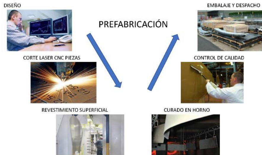
ILUSTRACIÓN N° 1 PREFABRICACIÓN ESTANQUE APERNADO
