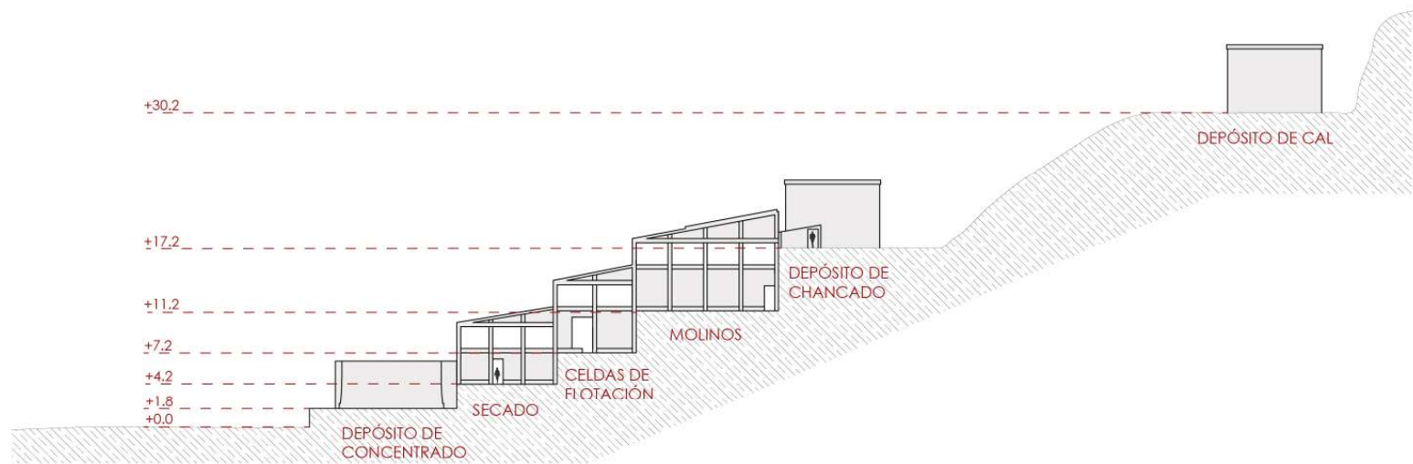
Fig.64. Elevación poniente de la Planta de Concentrado. Fuente: Elaboración propia.
