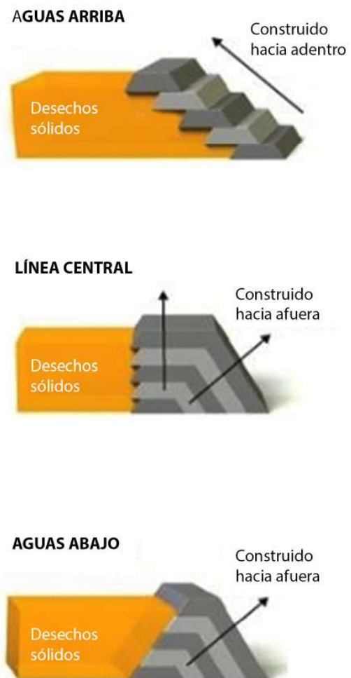
Fig.25. Tipos de presas de relave. Fuente: clickpicx.pw.
