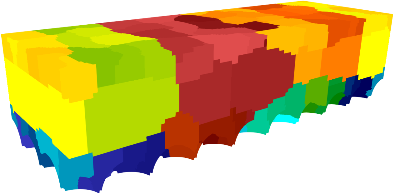
Figura 3.3.: Descomposición del dominio de simulación para resolución de ecuaciones en paralelo.
