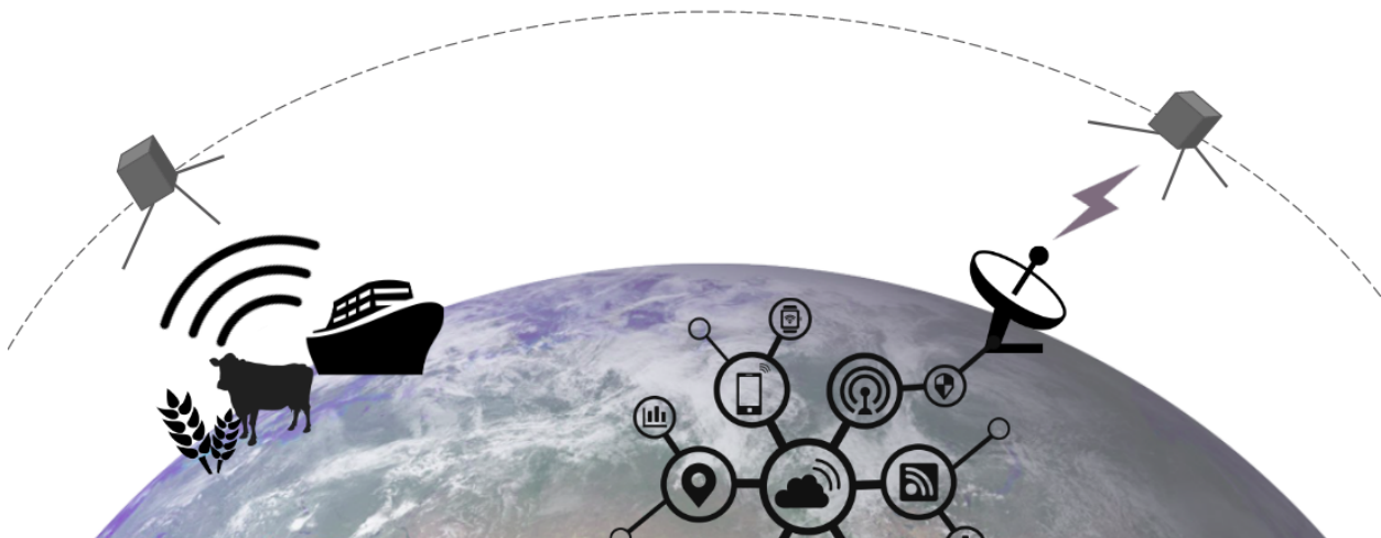
Figura 3.1: Escenario ilustrativo en el que un CubeSat -o una constelación de ellos- provee conectividad para aplicaciones IoT en la modalidad store and forward .
