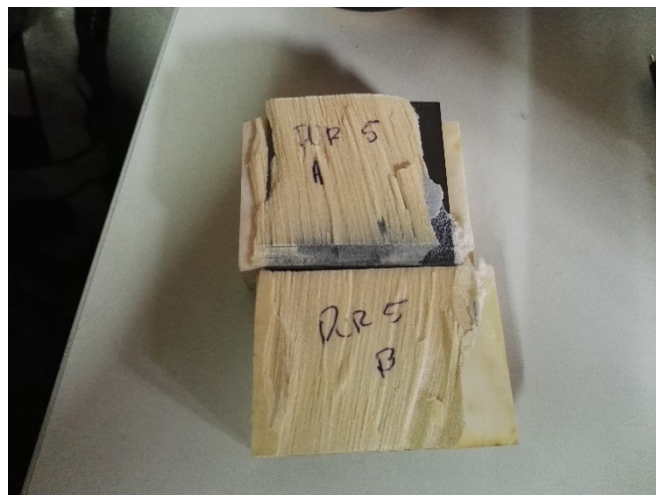
Figura 18: Probeta con refuerzo pegada con poliuretano
