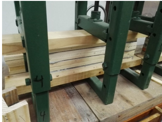
Figura 2: Prensado muestras pegadas con Sikadur 30
