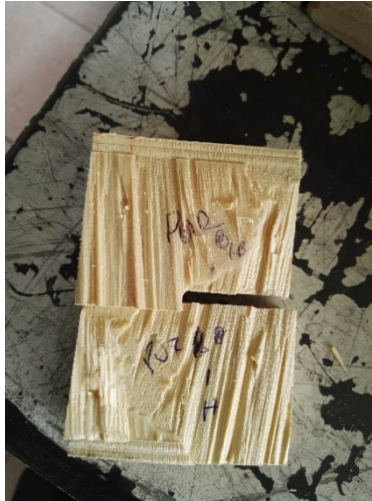
Figura 19: Probeta testigo pegada con poliuretano
