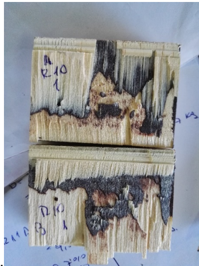
Figura 16: Probeta ensayada con el adhesivo Resorcinol testigo
