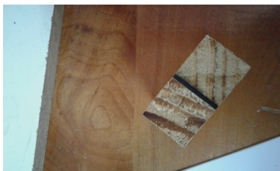
Figura 11: Probeta pegada con Poliuretano desde otro ángulo
