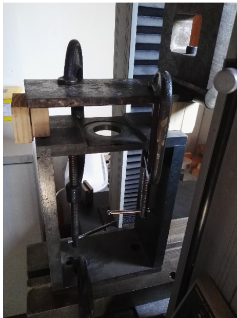
Figura 9: Máquina de ensayo en donde se realizó el estudio de cizalle
