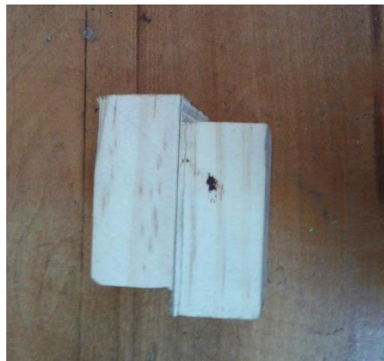
Figura 8: Probeta testigo pegada con adhesivo Poliuretano
