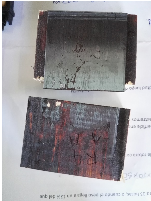
Figura 17: Probeta con refuerzo y pegada con resorcinol
