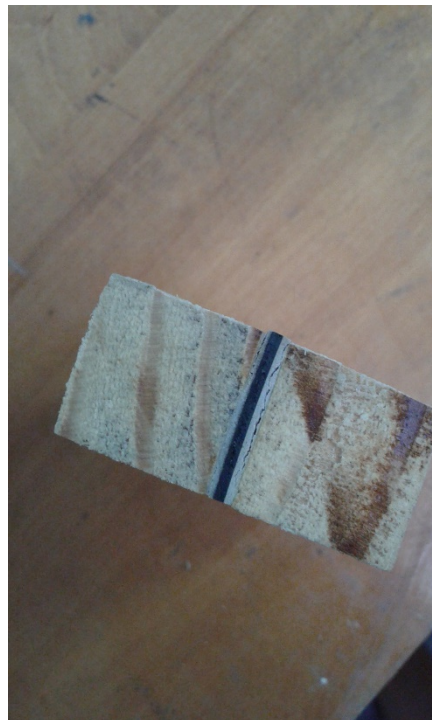
Figura 31: Resquebrajamiento de una probeta en línea de cola usando Sikadur 30
