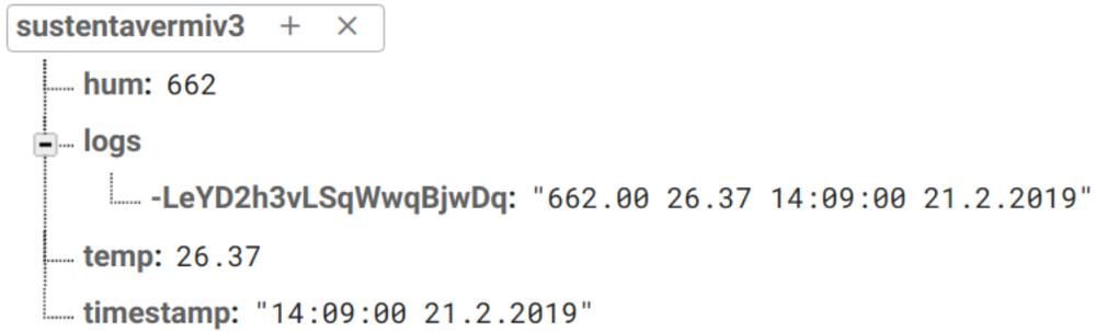
Figura 4.15: Estructura del documento JSON en la base de datos Firebase que guarda los datos históricos. Posee 3 campos que se actualizan en tiempo cuasi-real llamados: *hum*, *temp* y *timestamp* y 1 campo secundario llamado *logs*, el cual almacena los 3 campos principales separados por un espacio a lo largo del tiempo.
