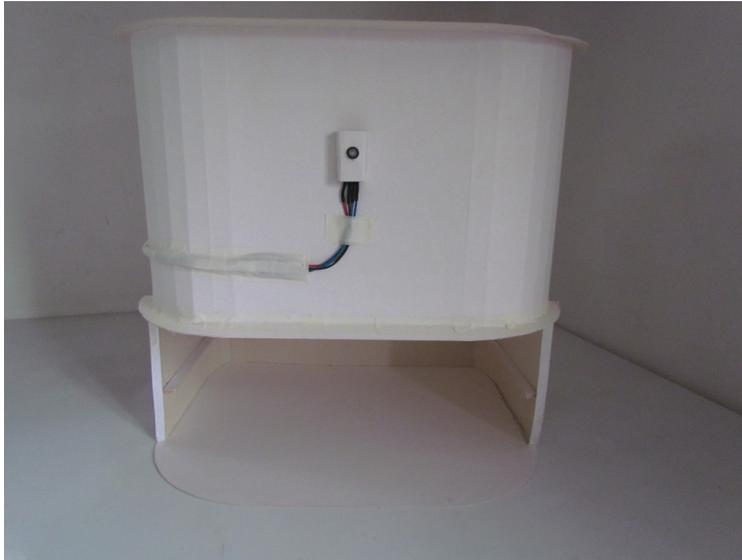
Figura 4.25: Vermi 2.0 sin su carcasa externa, se muestra el cableado del led RGB y el propio led RGB. La carcasa externa tiene un logo transparente hecho con mica translúcida que queda situado justo por delante del led. Fuente: Camila Martín.
