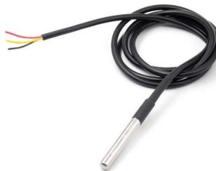
Figura 4.7: Termómetro Digital DS18B20 con su cubierta impermeable. Posee 3 cables, el rojo para la alimentación, el negro para la tierra y el amarillo para la transmisión de datos.
