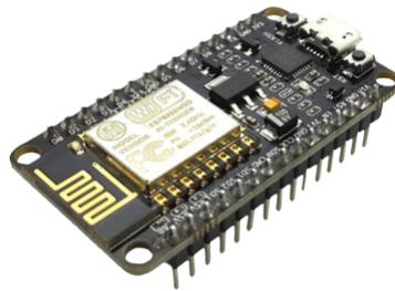
Figura 2.4: Microcontrolador ESP8266, ESP-12E o NodeMCU1.0 Fuente: <https://www.letstango.com/esp8266-serial-wifi-module-nodemculuawifi-v3>
