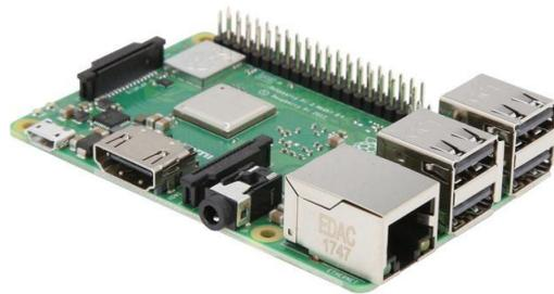
Figura 2.3: Raspberry Pi 3 Modelo B+. Es un pequeño computador. Fuente <https://www.newegg.com/raspberry-pi-2773729-1gb-1pddr2-sdram/p/N82E16813142011>
