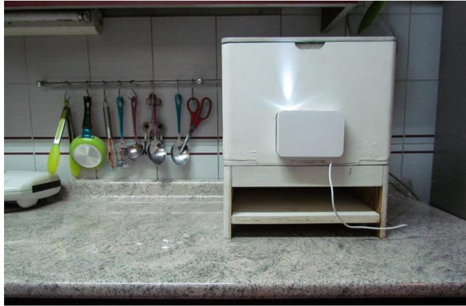
Figura 4.13: Primer prototipo de la Vermi instalado en una cocina. Está construido en terciado de pino insigne, un material barato y fácil de trabajar en una CNC. Tiene un sellado interior hecho con aceite de linaza, protegiendo la madera de la humedad. Fuente: Camila Martín.
