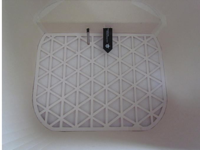
Figura 4.23: Sensores de Temperatura (izquierda) y Humedad (derecha) instalados en la Vermi 2.0. Se observa una malla diseñada para permitir un arneado del hummus. Fuente: Camila Martín.
