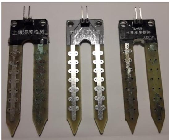
Figura 4.18: Sensores de Humedad YL-69. Al centro se observa un sensor YL-69 nuevo y a ambos lados otros dos utilizados en la Vermi 1.0, los cuales presentan signos de corrosión.
