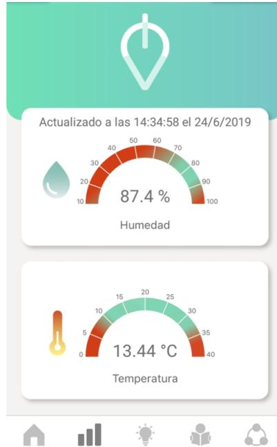
Figura 4.33: En la segunda pantalla se muestra el *Dashboard* de la aplicación, el cual funciona como un visor en tiempo cuasi-real de la humedad y temperatura del vermicompost. Las medidas se actualizan cada 1 hora desde el circuito y la aplicación responde frente a estos cambios periódicos en la base de datos.
