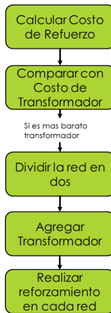
Figura 3.18 Esquema de reforzamiento de transformador por costo
