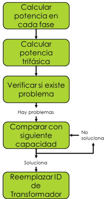
Figura 3.17 Esquema de refuerzo de transformador por capacidad
