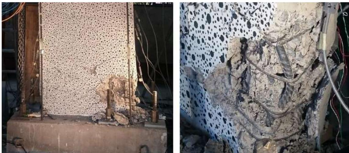
Figura 3.12: Estado espécimen W1 para deriva de 4.5% (Massone et Al., 2017)
