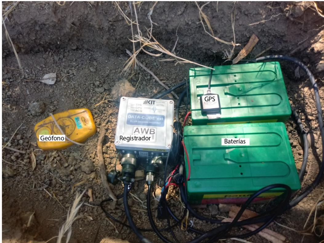
Figura 4.2: Ejemplo de las partes de una estación sismológica: geófono de tres componentes, el registrador *Data-Cube*<sup>3</sup>, un GPS y una fuente de poder que en la imagen son baterías de litio.
