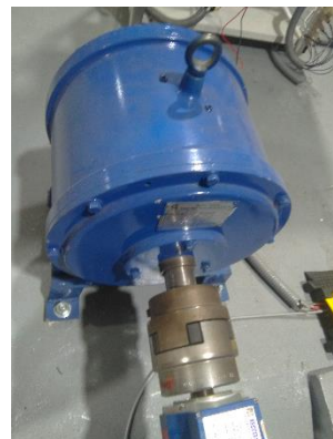
Figura H.25: Generador de microcentral hidráulica en solitario.
