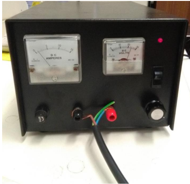
Figura H.33: Fuente de poder para instrumentos, válvulas y controlador del servomotor.
