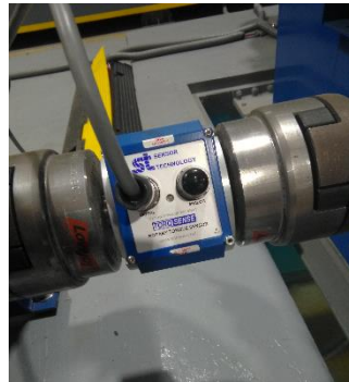
Figura H.23: Torquímetro/tacómetro conectado.
