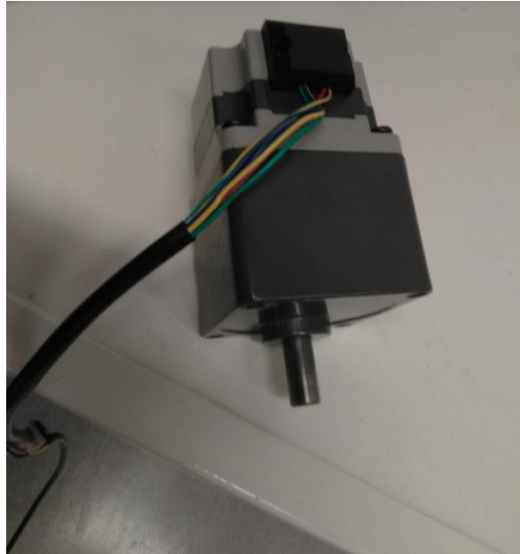
Figura H.31: Servomotor de solución propuesta.
