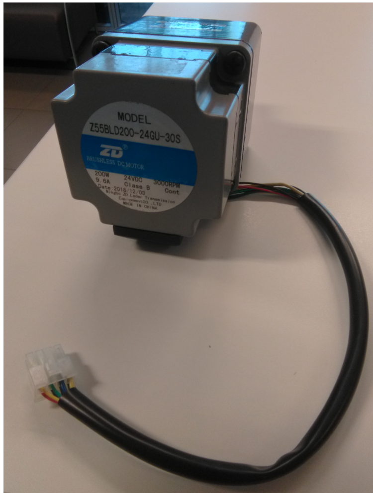
Figura E.1: Servomotor con caja reductora de velocidad, orientación de frente.
