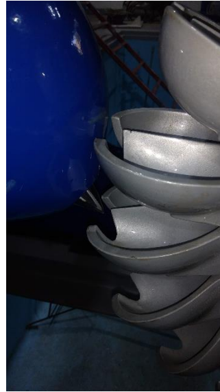
Figura H.21: Detalle de cucharas de microturbina hidráulica con aguja del inyector.
