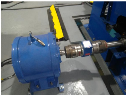
Figura H.24: Generador de microcentral hidráulica con eje y torquímetro.
