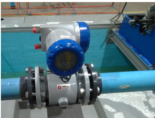
Figura H.13: Caudalímetro de microcentral hidráulica.
