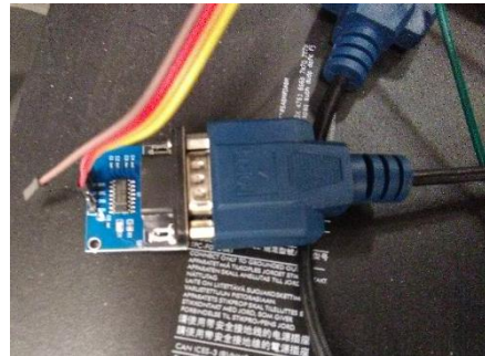
Figura H.35: Convertidor TTL-RS232 conectado con puerto de tarjeta de adquisición.
