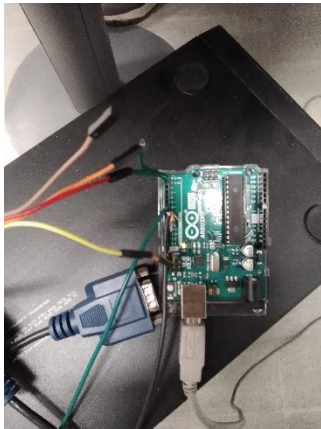
Figura H.34: Arduino encendido y conectado con servomotor para convertir su señal.
