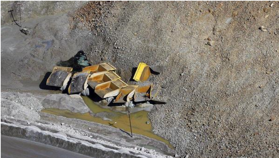
Figura 44. Camiones mineros enterrados por el deslizamiento ocurrido en Bingham Canyon el año 2013 (Llano-Serna et al, 2016).
