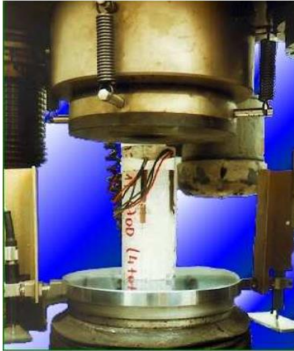
Figura 110. Foto de un ensayo uniaxial en una probeta de roca.
