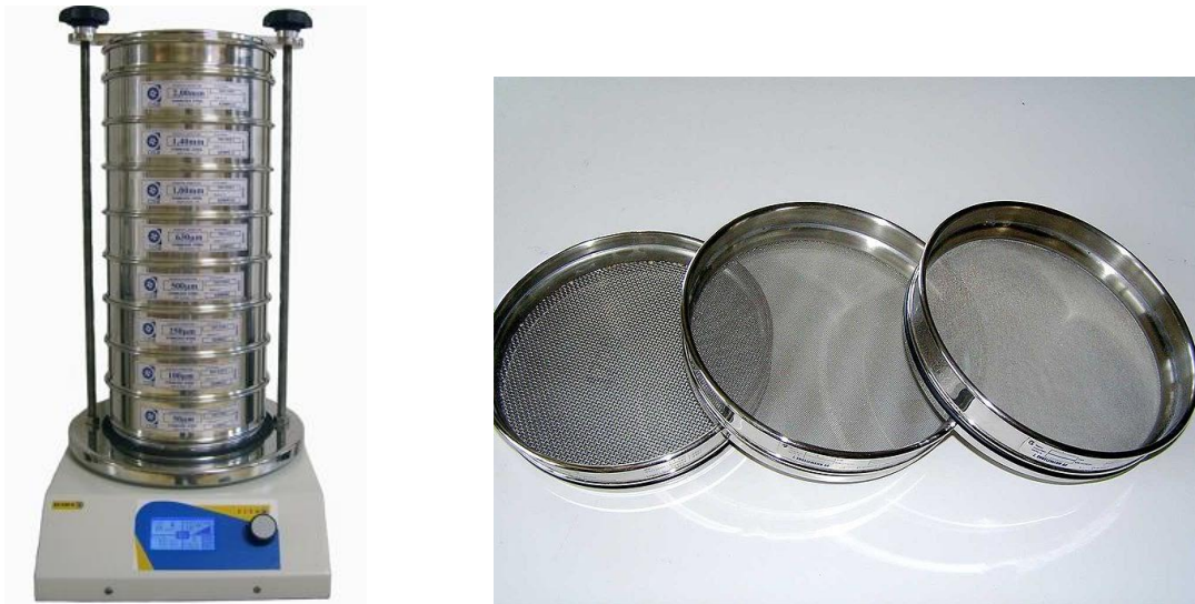
Figura 8. Imagen de tamizador analítico y cribas de acero inoxidable utilizadas en la separación de muestras. Solo las muestras de minerales puros fueron sometidas a este tipo de tamizaje, durante 10 minutos.
