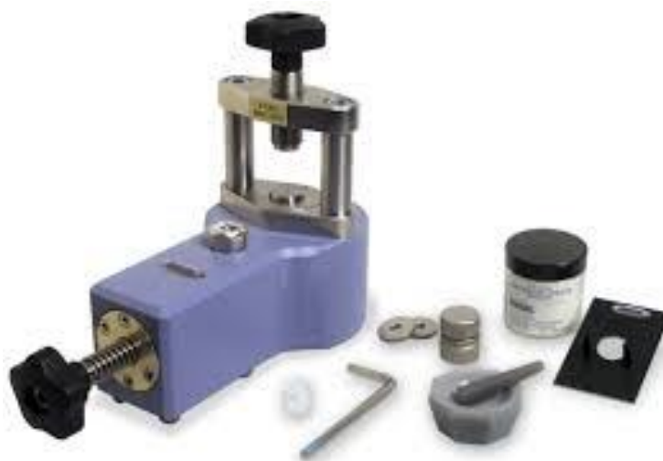
Figura 13. Prensa hidráulica para pellets Specac, diseñada para la preparación de pastillas de 7mm de KBr para análisis de FT-IR, con una capacidad máxima de aplicación de 2 toneladas. Las pastillas de este trabajo se someten a 1.7 toneladas durante 2 minutos en esta prensa.
