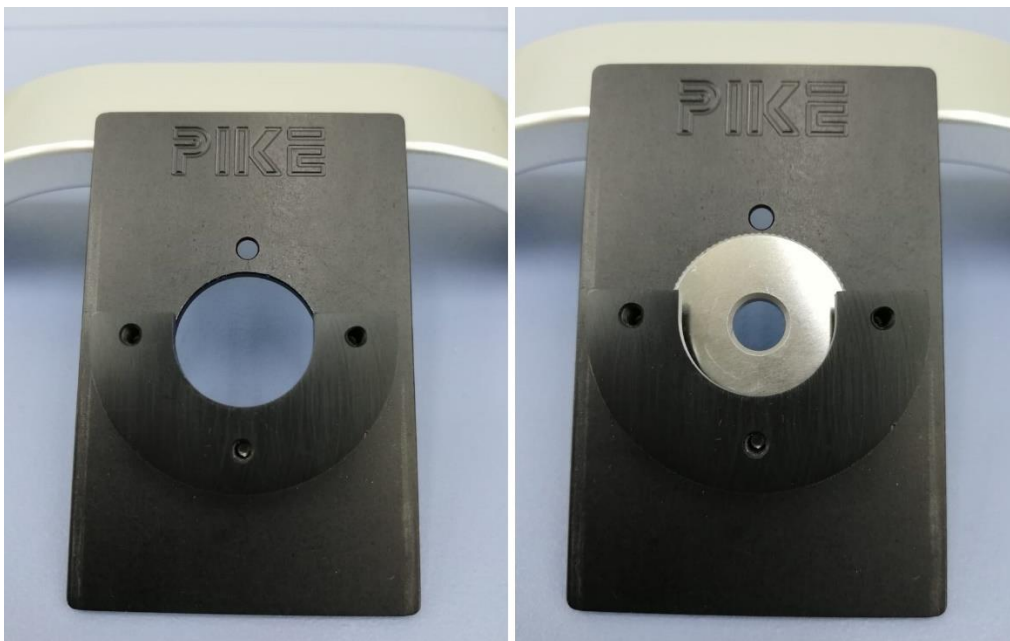
Figura 6. Soporte removible (Pike) en el cual se instala el anillo de sujeción que contiene la pastilla de KBr con la muestra. Posteriormente es el soporte el que se ingresa al compartimiento de muestras del espectrómetro FT-IR.
