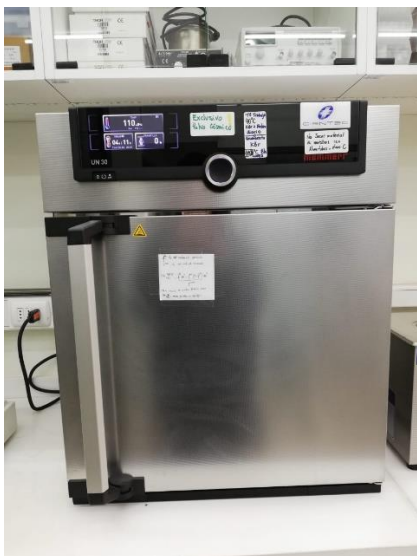
Figura 10. Estufa de laboratorio Memmert digital de 32 L, modelo UN30. Horno de convección natural, con textura cubierta de acero inoxidable con 2 puntos de bloqueo (cerradura de la puerta de compresión), y doble rejilla de acero inoxidable interna.
