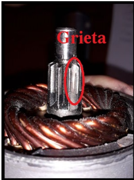
Figura 4.6: Sol del reductor con nivel de falla 2.
