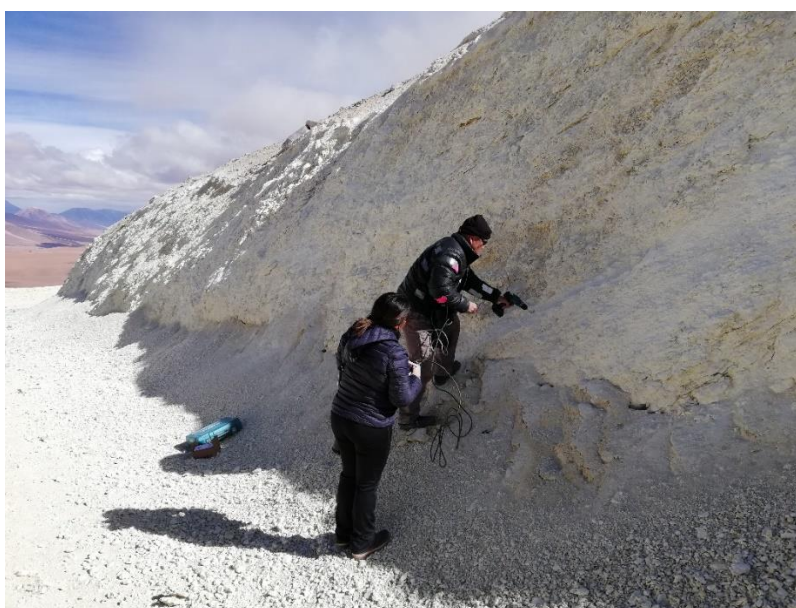
Fotografía 3. Perforación con taladro para medición in situ en pumita blanca en punto P1
