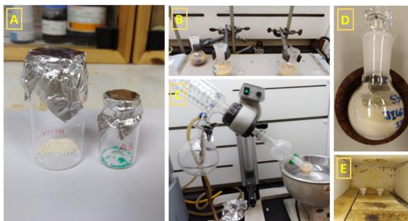
Figura 6 Imágenes correspondientes al set up experimental utilizado para la formación de los composites NiO@UIO-66, las que representan: A) los materiales de partida para la impregnación (MOF UIO-66 vaciado y sal metálica de Ni), B) la agitación de las suspensiones del MOF UIO-66 y la solución acuosa de Ni, C) la evaporación controlada del solvente en un evaporador rotatorio, D) el producto Ni(NO 3 )@UIO-66 y E) la formación de los composites NiO@UIO-66 mediante la calcinación.
