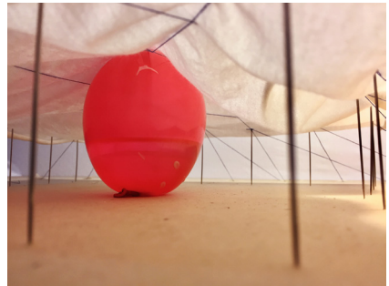
Fig Inferior: Modelo de tensores sosteniendo cargas verticales vista ampliada.
