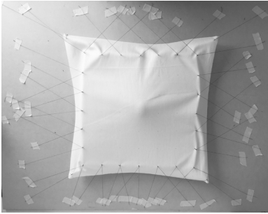
Fig Izquierda: Ensayo de tela a corte, los esfuerzos en la tela producen líneas de corte, que indican el funcionamiento a tracción de la estructura.
