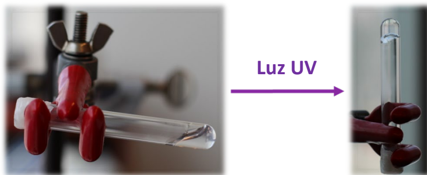
Figura 14. Prueba del tubo invertido que demuestra la formación del hidrogel mediante fotoentrecruzamiento covalente de los biopolímeros metacrilados.
