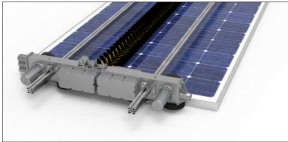
Figura 12-8 Modelo del Robot de limpieza (Elaboración Propia)
