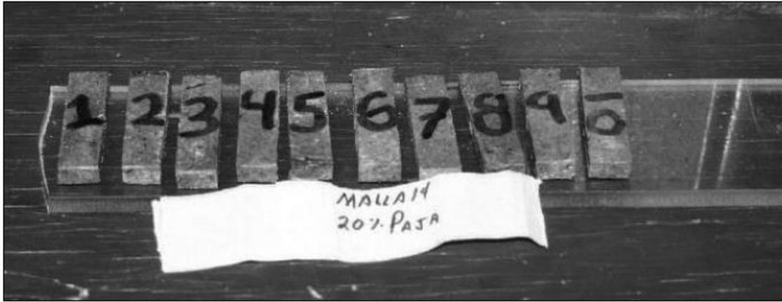
Figura 7: Probetas de madera plástica para ensayos de impacto (García et al., 2013).
