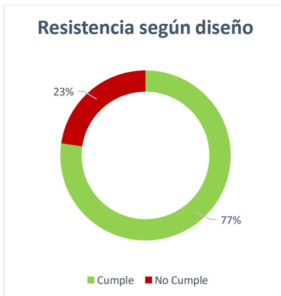
Figura 39: Porcentaje de muestras que cumplen con la resistencia a la compresión de diseño.
