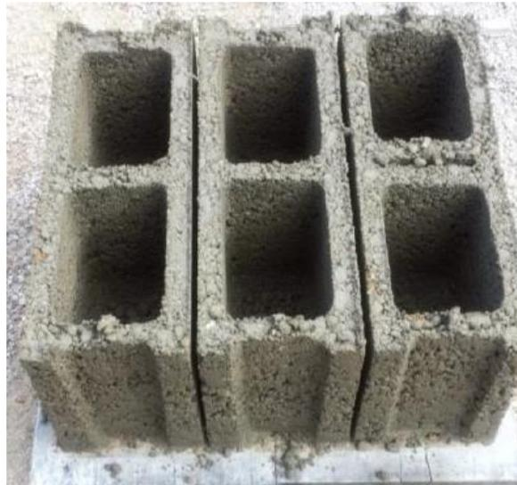
Figura 31: Bloque de hormigón H15 fabricado para los ensayos (Beltran y Ferreira, 2018).
