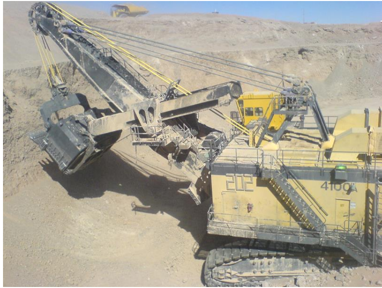
Figura 2.3 Pala de cables o eléctrica.
