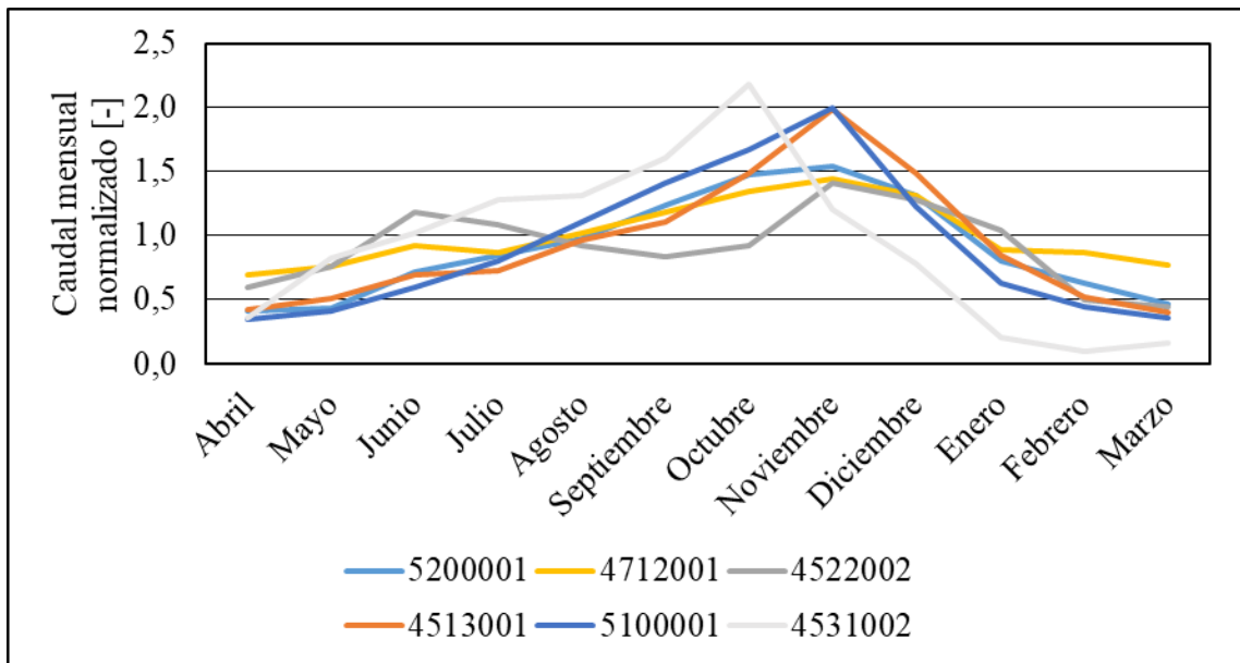
Figura 3. 7: Caudales medios mensuales normalizados de cuencas con régimen Nivo Pluvial entre los años 1985 y 2015.
