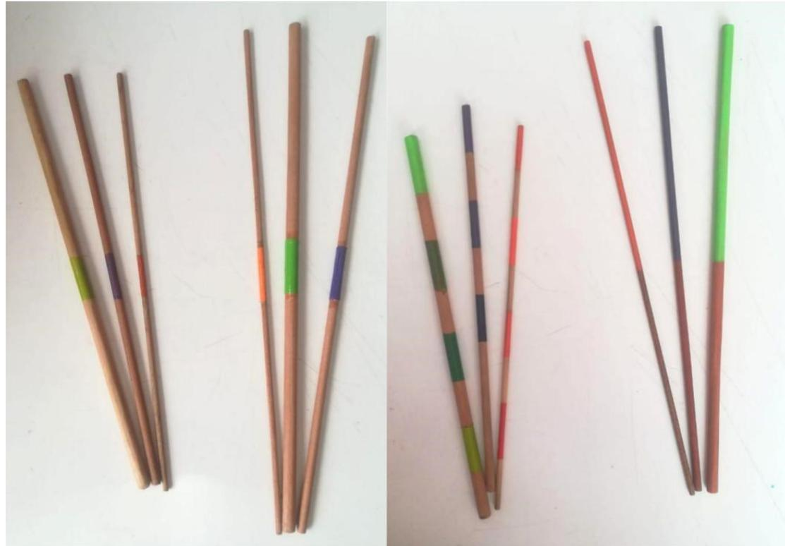
En primera instancia, las varillas fueron de 20 cm. de longitud y marcadas con color en el centro, pero se observó que para las dimensiones interiores del cilindro estas se saldrían de su posición de guardado, por lo que se decidió extender su longitud a 24 cm, como es posible observar en la *Imagen 49*.
