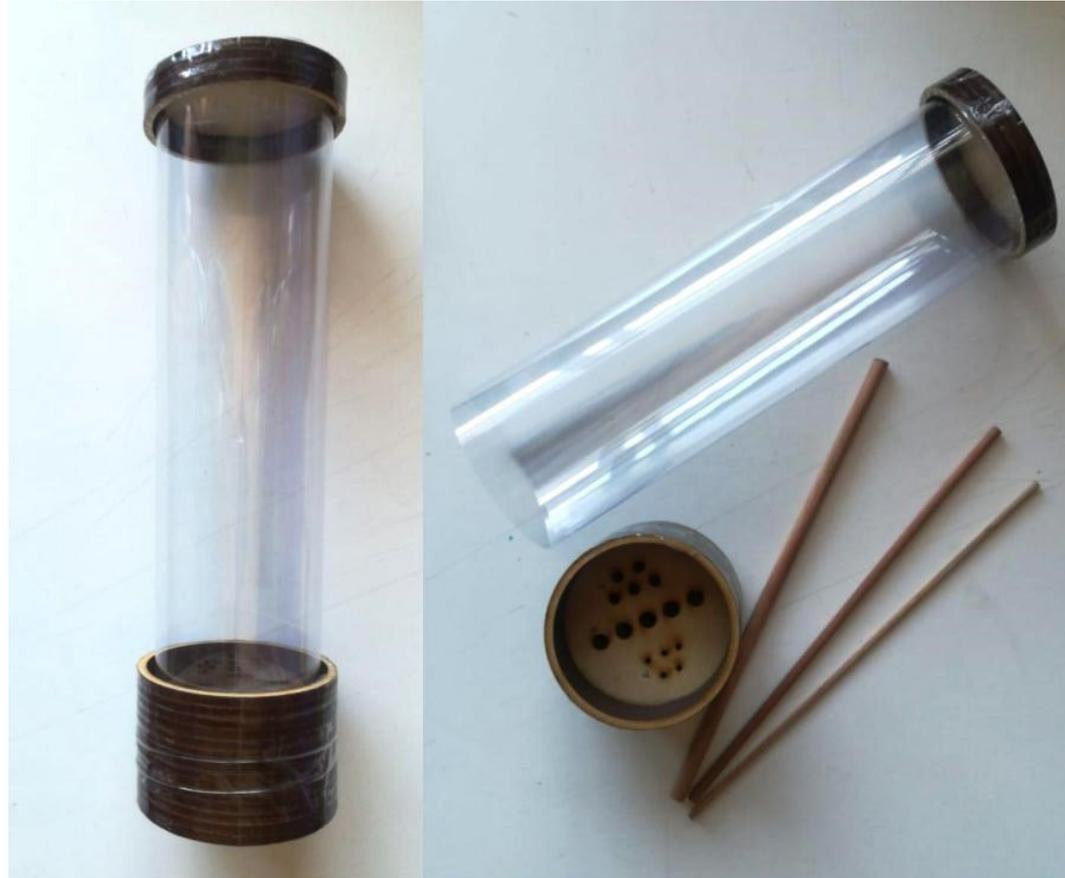
Con este prototipo se realizó una verificación de medidas (diámetros) con la terapeuta, encargada de las sesiones de equinoterapia considerando el agarre. Se verifican también los diámetros propuestos para las varillas (3mm, 4mm, 6mm), los cuales fueron aceptados y dio paso a revisar las perforaciones del interior de la base, donde serán guardadas al encontrarse en desuso y a la cual se le hicieron algunas observaciones respecto del número de capas.
