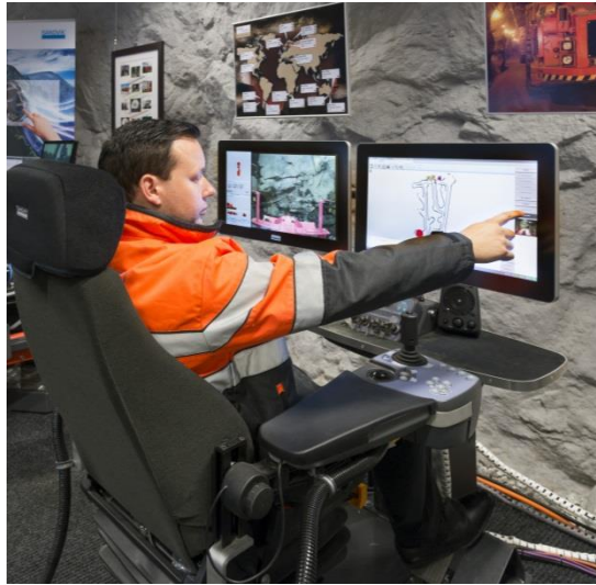
Figura 1-1: Estación de trabajo de equipos operados a distancia
