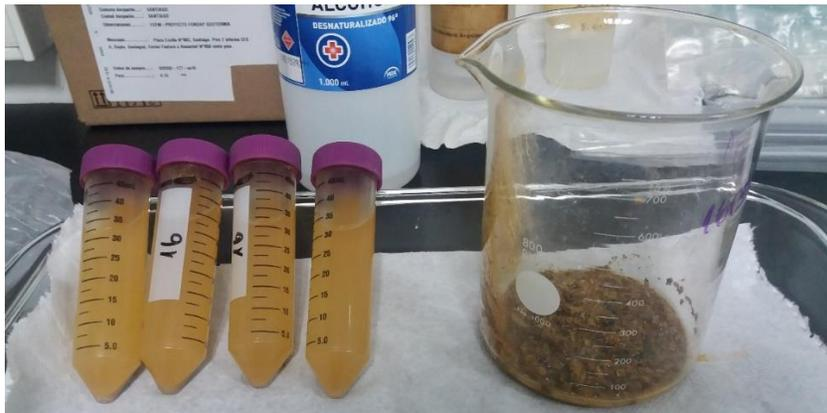
Figura 5. Tubos utilizados para el proceso de centrifugado de muestras, proceso que forma parte de la separación de la fracción arcilla de las muestras.
