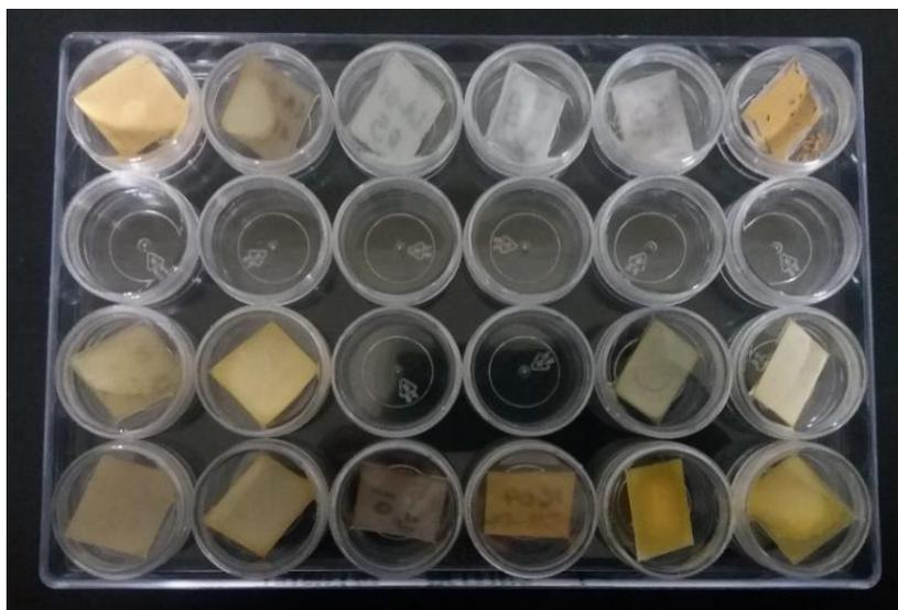
Figura 7. Muestras montadas y listas para envío a difracción de rayos X (XRD).
