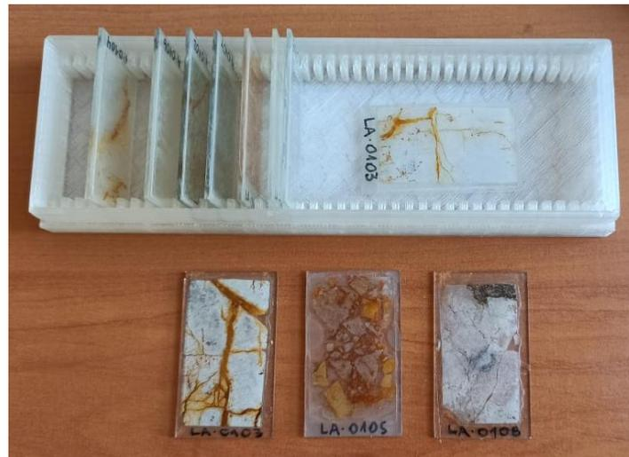
Figura 3. *Quick plates* utilizados en este trabajo. Su uso permite identificar los arreglos de inclusiones fluidas, o *fluid inclusion assemblages* (FIAs) presentes en la roca, además de complementar información de mineralogía y texturas.
