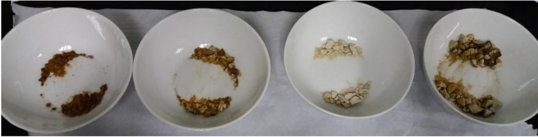
Figura 4. Separación de muestra para detección de carbonatos y/o materia orgánica.
