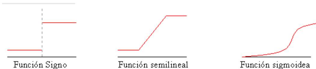
Figura 18: Funciones de activación de una red neuronal
