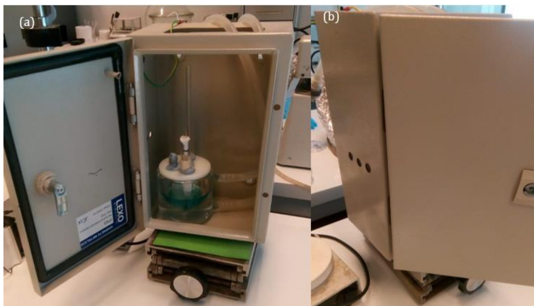
Imagen 4: (a) Celda dentro de la caja metálica. (b) Exterior de la caja metálica. Los tres orificios son para entrada de cables.
