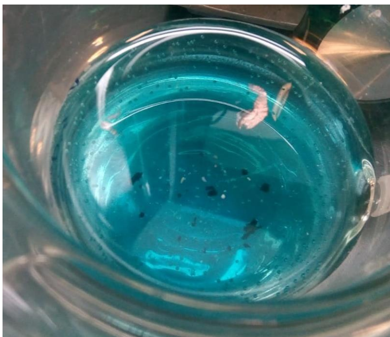
Imagen 17: Fragmentos de depósito sintetizado a 60°C por una hora, decantado en la solución.
