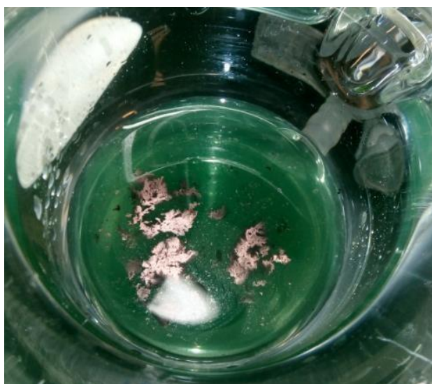
Imagen 15: Depósito desprendido durante una prueba de electrodeposición superior a una hora en un sustrato de titanio.
