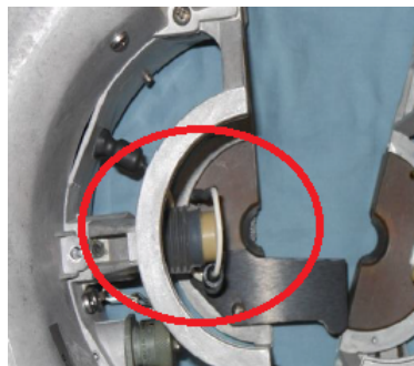
Figura 9.7: Monitor de temperatura en PowerDonut.
