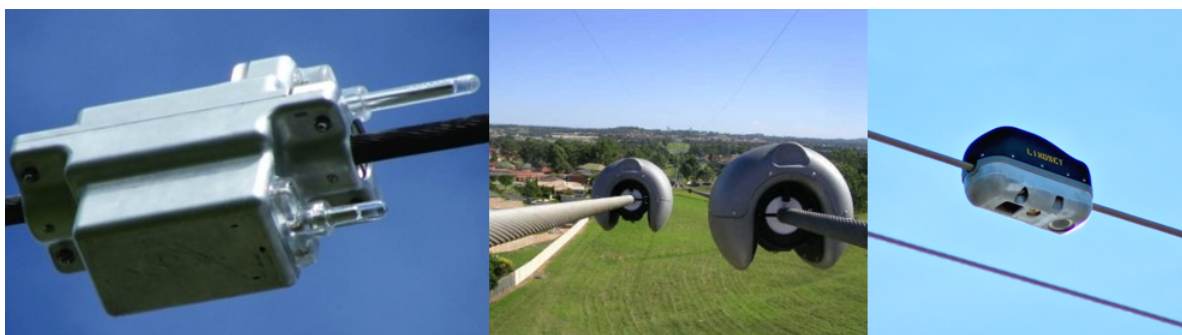
Figura 9.5: Monitores de línea de Ampacimon, OTLM y Lindsey.[35] [36] [37]
