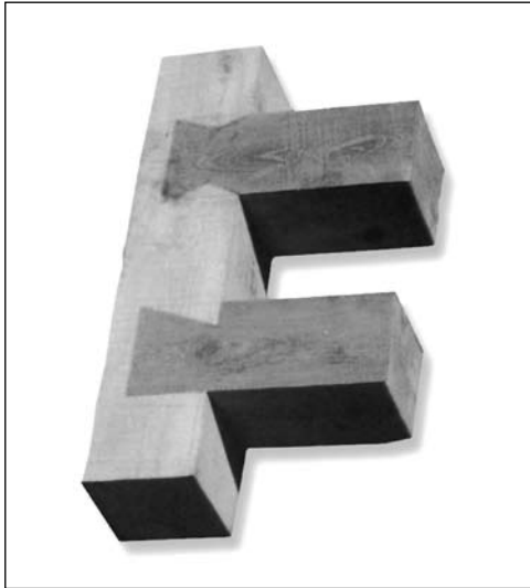
Figura 8: Ensamble de tipo cola de milano.
