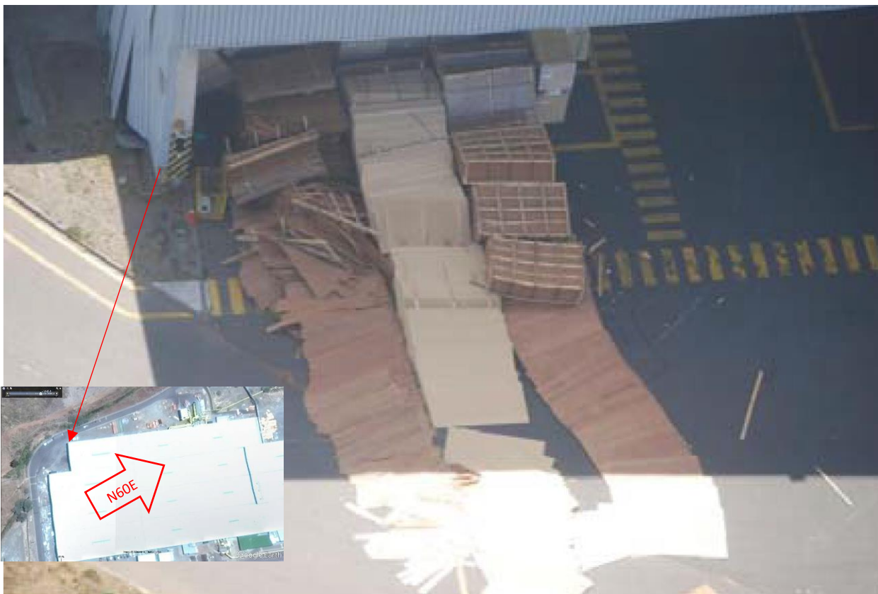
Fig. 5.58 Desplome de material apilado en planta Nueva Aldea [67].
