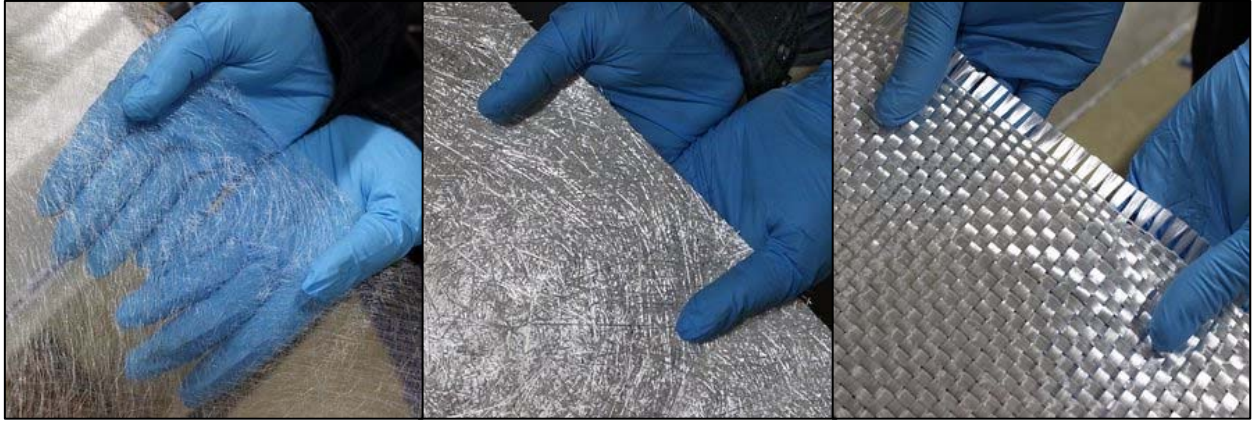
Figura 2.5 – Velo, estera y tejido de fibra de vidrio (de izq. a der.) [9].
