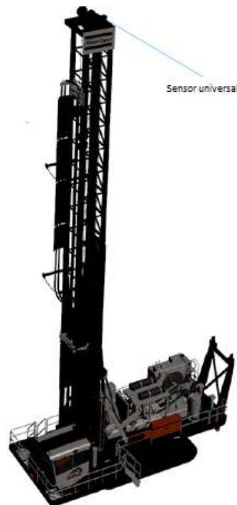
Figura 14. Equipo externo en la parte superior del mástil de perforadora.
