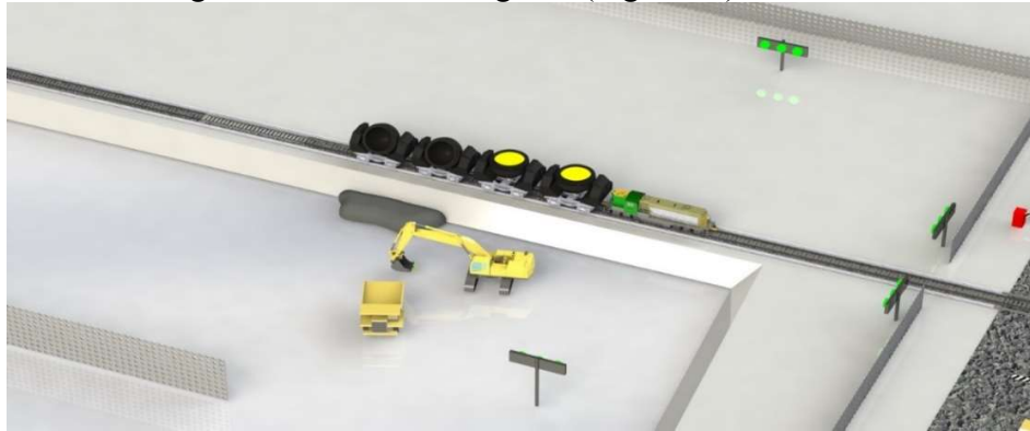
Figura 21. Descarga de los vagones
