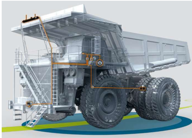
Figura 4. Equipo de Autonomous Solutions Inc. a bordo de un camión minero.
