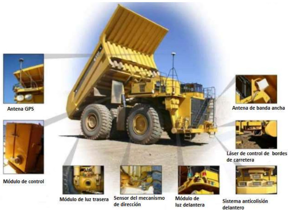
Figura 1. Camión autónomo Komatsu 930E-AT de 290 toneladas.
