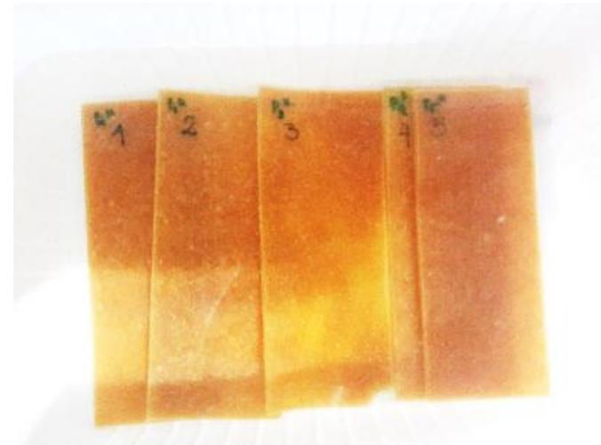
Figura 34. Probetas de 40x100 mm recién ingresadas en agua para prueba de absorción y espesor de hinchamiento.
