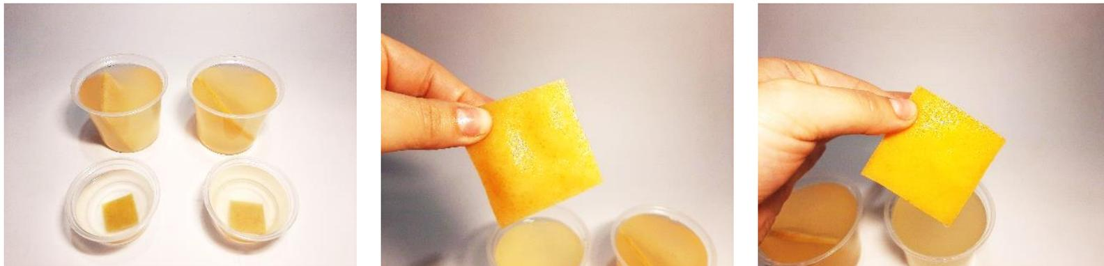
Figura 59. Fotografía proceso y resultado prueba de solubilidad en agua en reposo.
