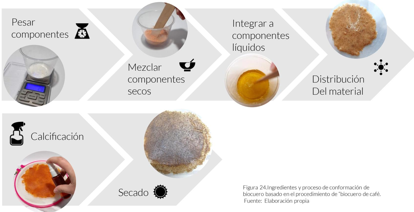
Figura 24. Ingredientes y proceso de conformación de biocuero basado en el procedimiento de "biocuero de café".
