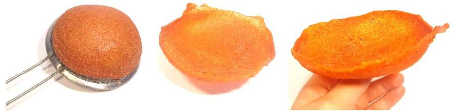
Figura 50. Fotografía Segunda prueba de conformado semiesfera en colador.
