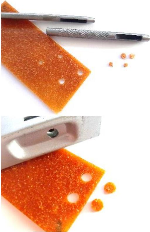
Figura 40. Fotografía de pruebas de perforado con sacabocado y perforadora.
