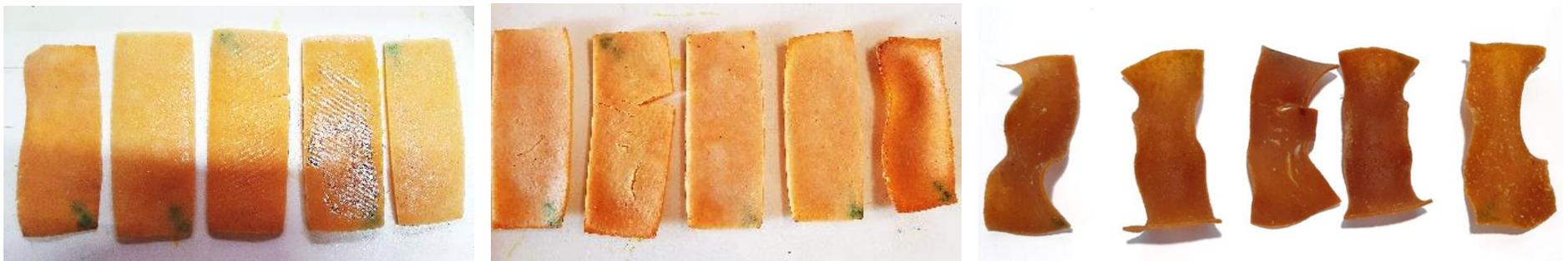
Figura 35. Probetas sometidas a prueba de absorción y espesor de hinchamiento. Fotografías sacadas a los 10 minutos, 24 hrs y 48 hrs de ser retiradas del agua
