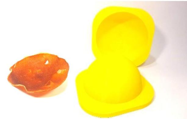
Figura 48. Resultado prueba de conformado de semiesfera y molde impreso en 3D.
