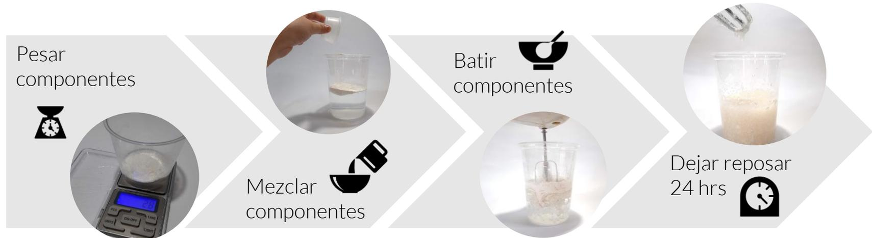
Figura 31. Proceso de preparación de solución de alginato al 6%
