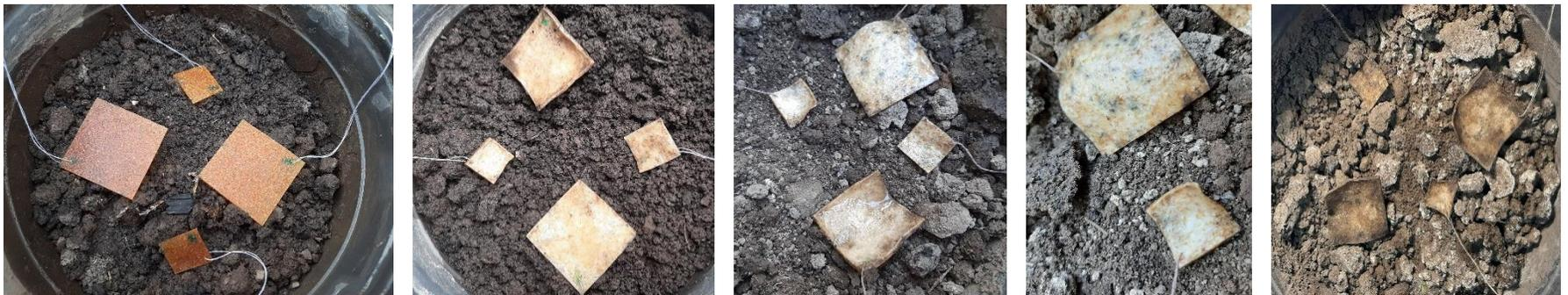
Figura 63. Fotografías prueba de degradamiento, tomadas una vez por semana durante 45 días.
