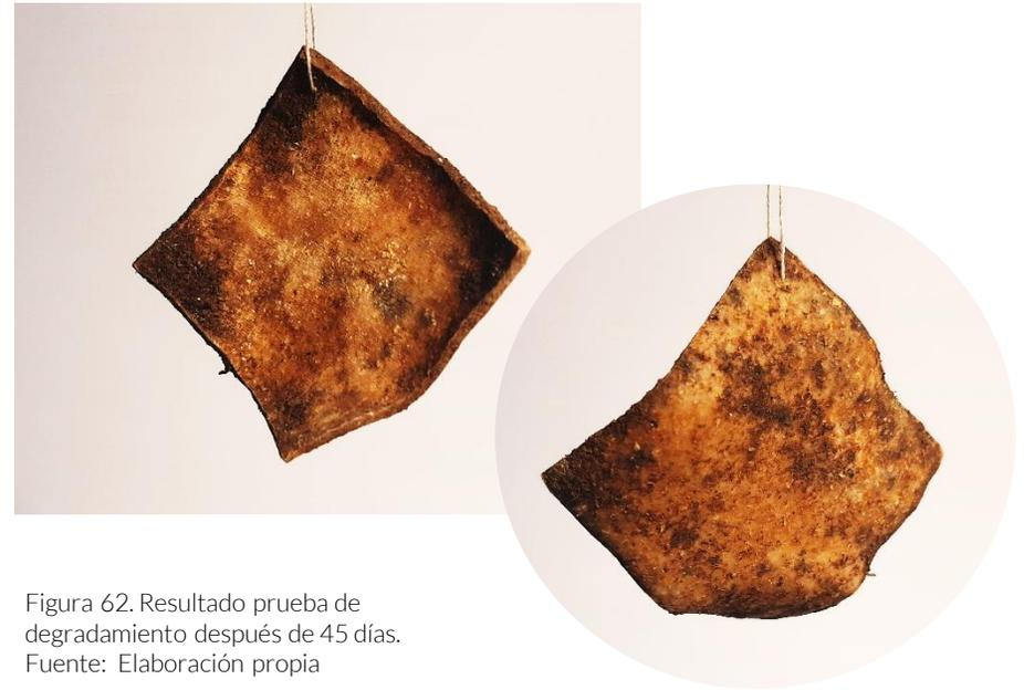
Figura 62. Resultado prueba de degradamiento después de 45 días.
