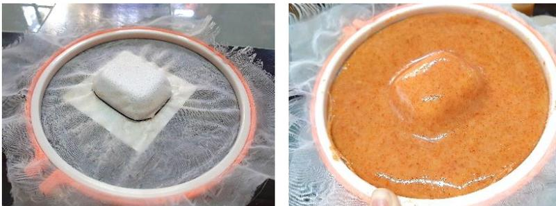
Figura 53. Fotografía proceso prueba de moldeabilidad con bastidor y pieza de polímero
