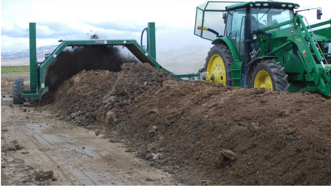
Imagen 2.3. Volteadora de compost acoplada a tractor. Fuente: www.compostandociencia.com
