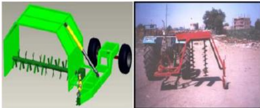
Imagen 2.5. A la izquierda sistema volteador de paletas, alta escala. Fuente: [7] A la derecha, sistema volteador de tornillos, pequeños agricultores. Fuente: [8]
