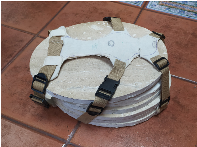
80. Arnés con peso para prueba 1 y 2 de la primera iteración de producto.
