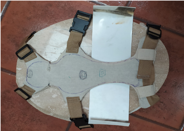
84. Modo de prueba segunda iteración con protección lumbar.
