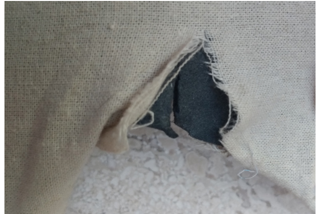
85. Resultado fisuras en textil y goma eva prueba 4.
