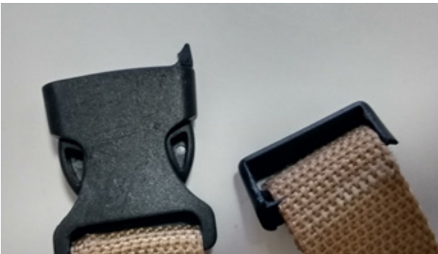
102. Broche polimérico roto, cinta inferior.
