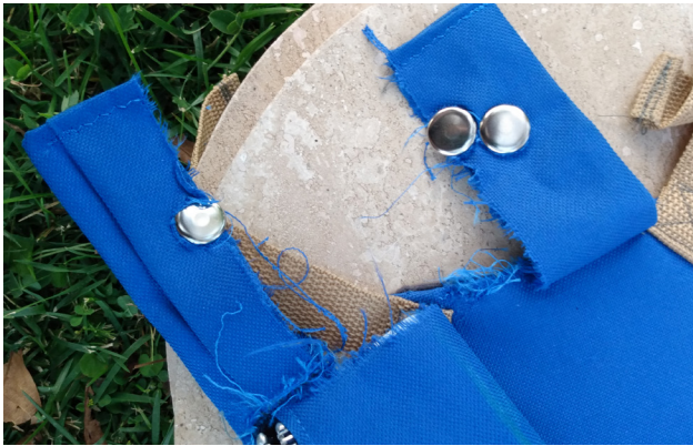
101. Zona de broches mal colocados.
