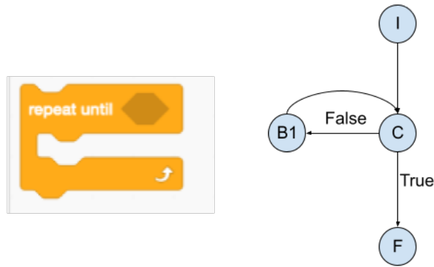
Figura 4.9: CFG para bloque repeat_until
