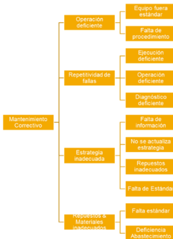
Gráfico 11. Pérdidas en Mantenimiento Correctivo Fuente: Elaboración propia
