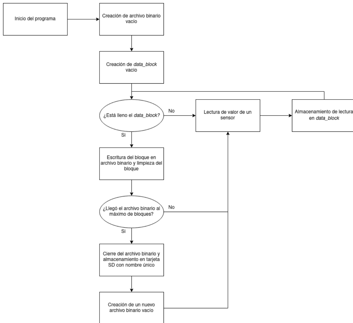
Figura 3.13: Diagrama de flujo del proceso de almacenamiento de datos
