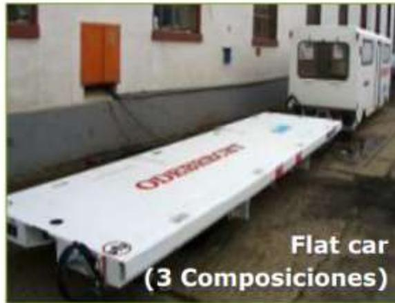
**Figura 2.12:** Flat car utilizado para el transporte de dovelas (Lewis Group, 2019).
