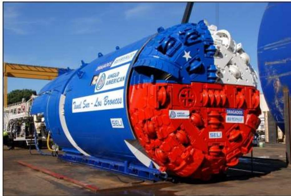
**Figura 2.24:** TBM Doble Escudo utilizada en Los Bronces (Barioffi et al, 2011).
