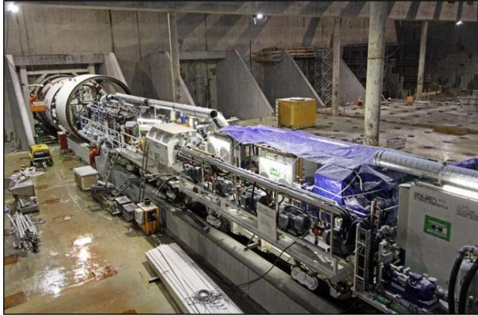
*Figura 2.5: Sistema back-up de una TBM de escudo simple (Herrenknecht AG,2021).*
