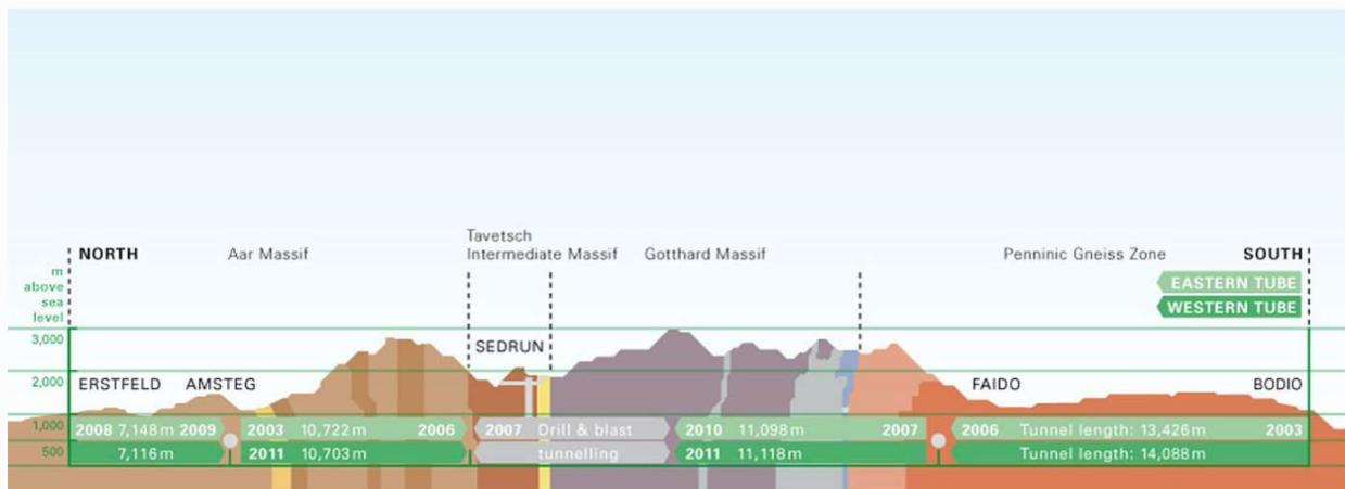
**Figura 2.25:** Longitud de los tramos de túneles construidos en el proyecto Base de San Gotardo (Herrenknecht, 2010).
