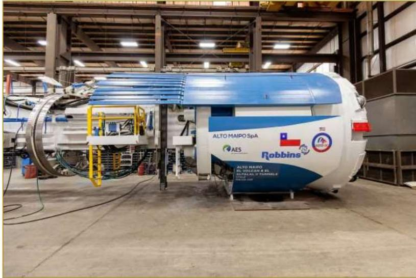
*Figura 2.27: TBM Gripper utilizada en el Proyecto Hidroeléctrico Alto Maipo (Robbins, 2020).*
